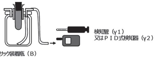
図4 手袋の指の部分を使用した簡易透過試験
